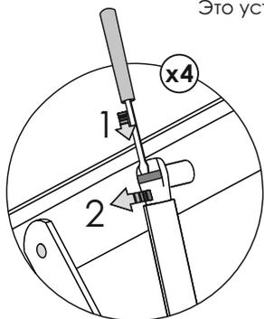
Для снятия газового амортизатора:
