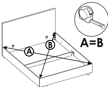
После регулировки периметра затяните винты
